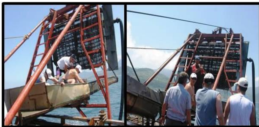
Снимка 2. Механична (традиционна) драга: Големина на устата 60*60*28cm, големина на окото на мрежата: 6 mm
