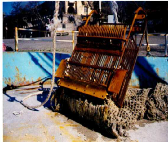
Fig.3 Dragă metalică de extracție de Chamellea galina din fundul de nisip moale
