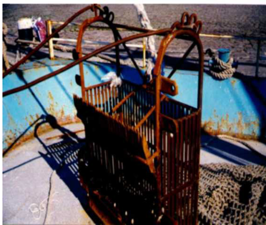
Fig.3 Dragă metalică de extracție de Chamellea galina din fundul de nisip moale
