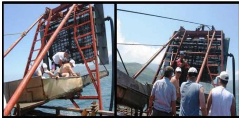
Fig.2 Dragă mecanică (tradițională): Mărimea gurii 60*60*28 cm, mărimea ochiului plasei: 6 mm
